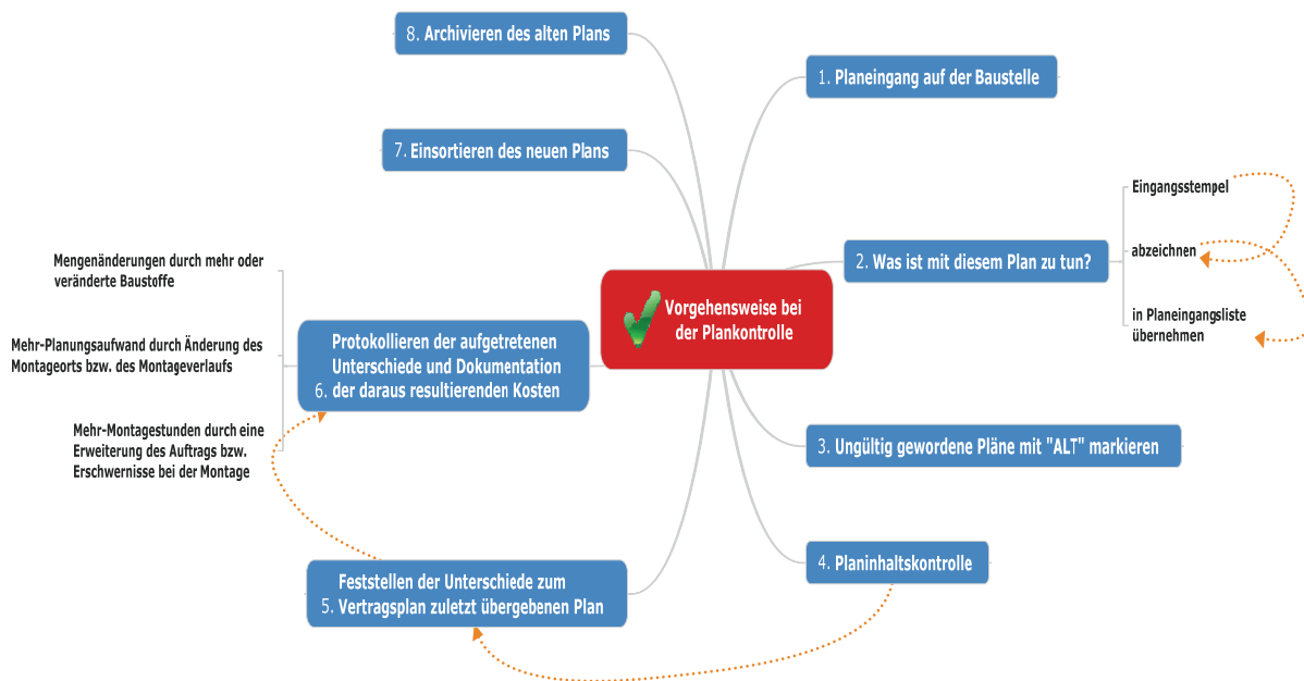
Abbildung 7-1: Vorgehensweise bei der Plankontrolle auf der Baustelle
